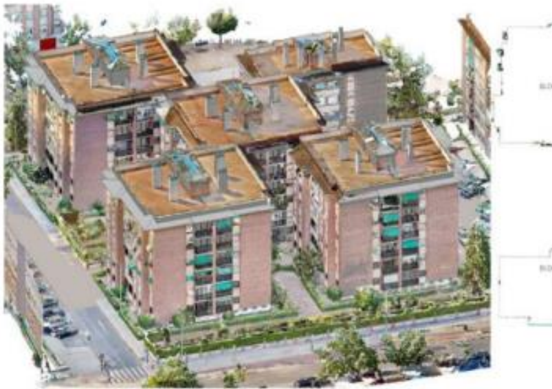
Modelado del edificio con nube de puntos
